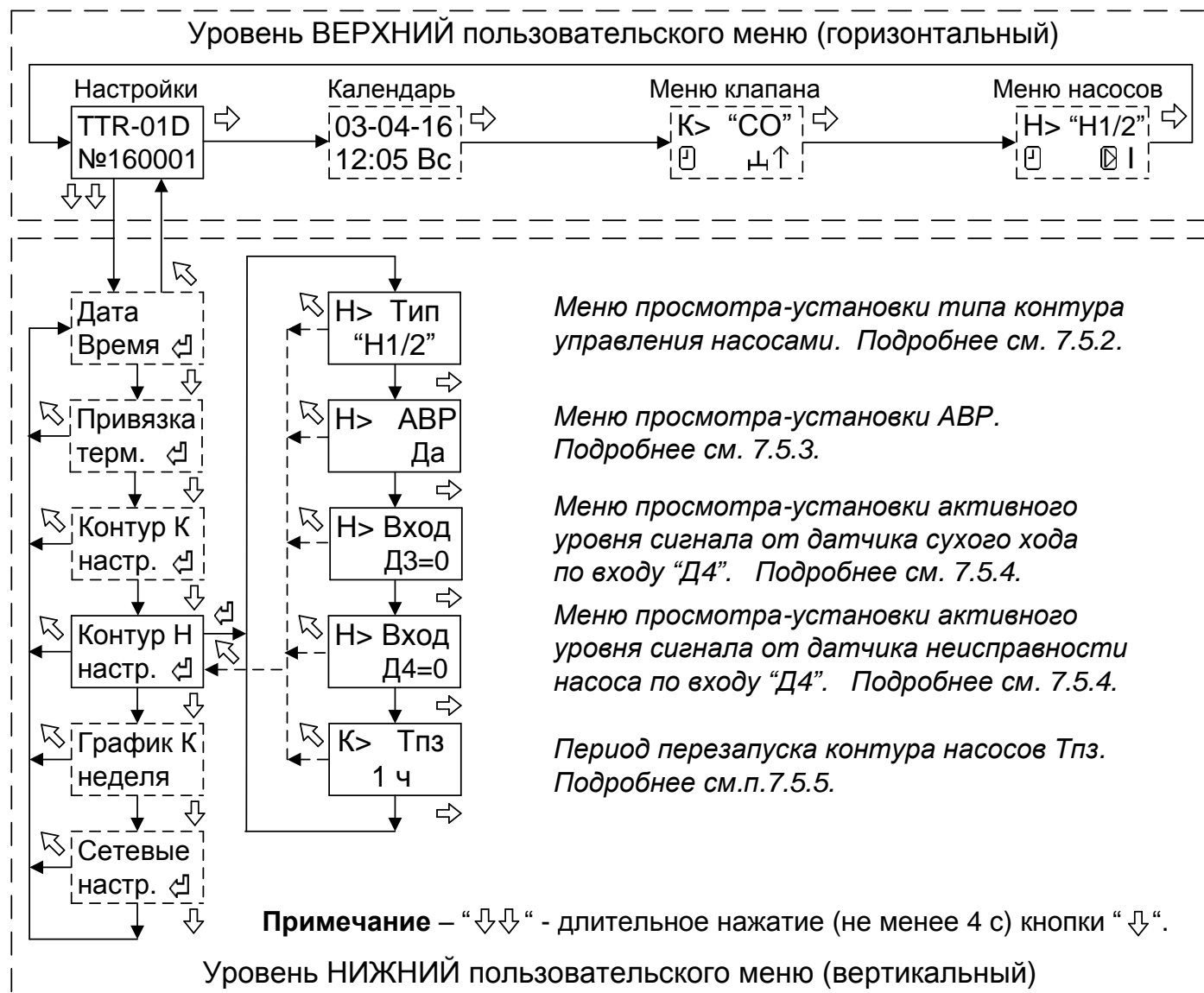
Рисунок 9 - Структура меню настройки параметров контура управления насосами.
