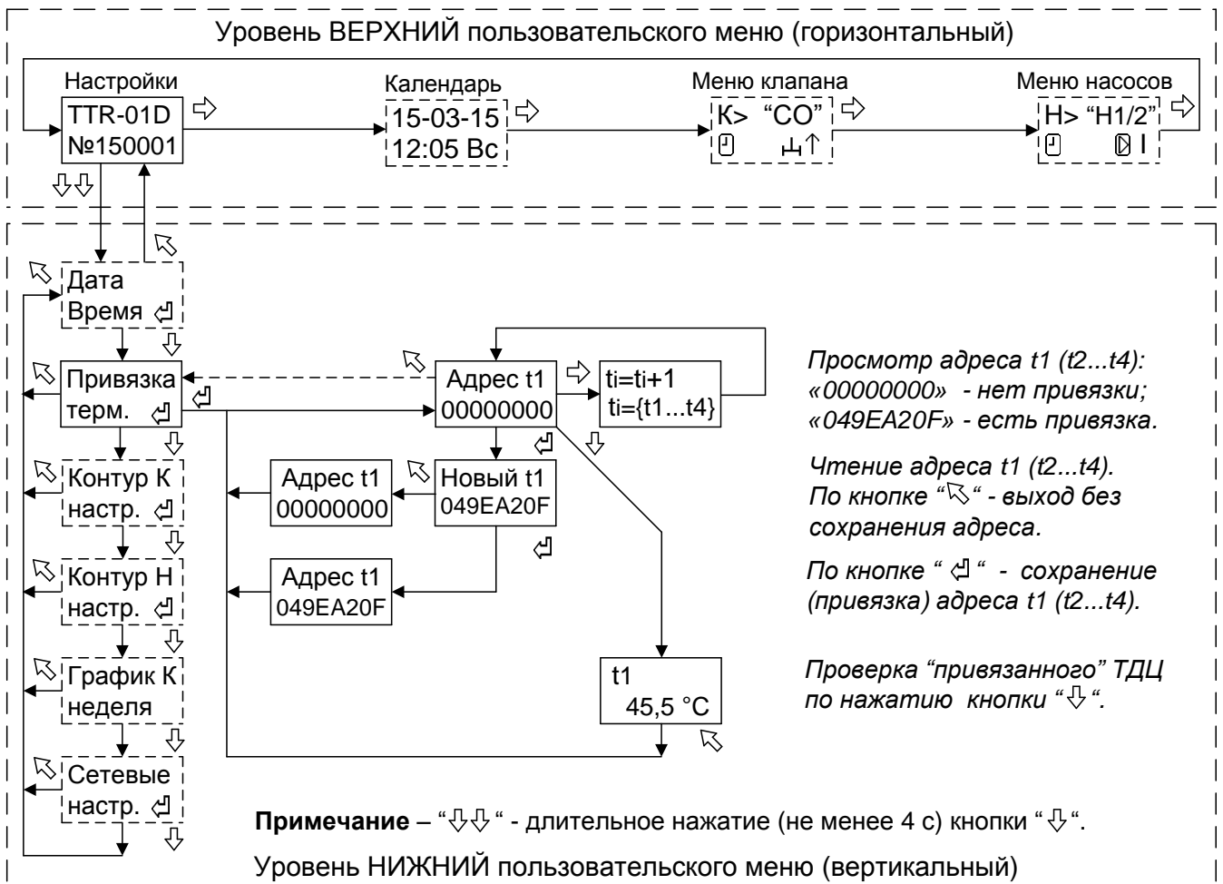
Рисунок 3 - Пример программирования (привязки) ТДЦ
